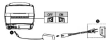
Primeiro conecte o cabo da fonte na impressora e depois na tomada.
