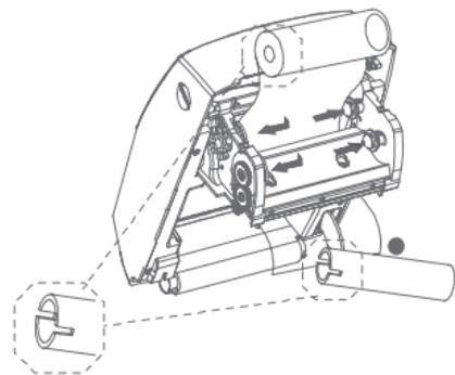
2. Antes de colocar o rolo de Ribbon e o tubete de papelão, note que eles têm cortes que se encaixam nas roldanas do lado esquerdo.
