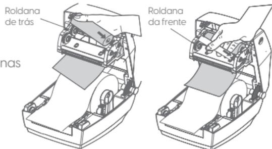
3. Desenrole uns 10 cm de Ribbon, e encaixe o rolo nas roldanas de trás. Depois, encaixe o tubete de papelão nas roldanas da frente.
